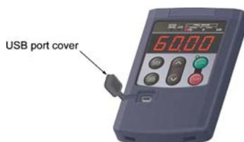
Collegando l'inverter al PC mediante un cavo USB è possibile eseguirne il controllo in remoto da FRENIC Loader. Sul PC in cui è in esecuzione FRENIC Loader è possibile modificare, controllare, gestire e monitorare i dati dei codici funzione in tempo reale, avviare o arrestare l'inverter e monitorare il funzionamento o lo stato degli allarmi dell'inverter.
