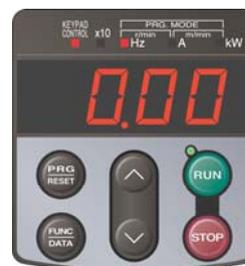
Figura 5.2 Visualizzazione sul display a LED dopo l'accensione
