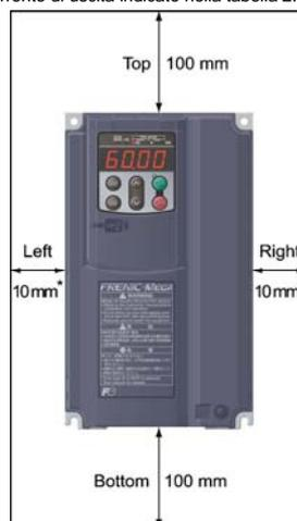
\* Per gli inverter con potenza di 1,5 kW o inferiore e 30 kW o superiore, mantenere una distanza di 50 mm tra il lato destro e sinistro e una distanza di 100 mm sulla parte anteriore.
